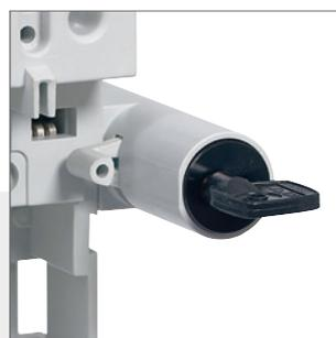
Le verrouillage par serrure ou cadenas empêche de remettre l'appareil en service sur sa base lors des opérations de maintenance.
