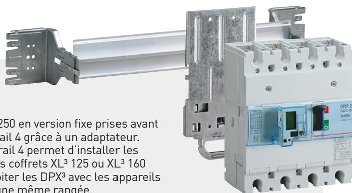
Les DPX<sup>3</sup> 160 et 250 en version fixe prises avant se montent sur rail 4 grâce à un adaptateur. Le montage sur rail 4 permet d'installer les DPX<sup>3</sup> 160 dans les coffrets XL<sup>3</sup> 125 ou XL<sup>3</sup> 160 ou de faire cohabiter les DPX<sup>3</sup> avec les appareils modulaires sur une même rangée.
