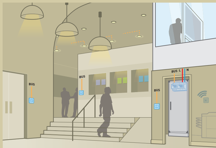
Alimentation par câbles (bus), reliant gestionnaire écran tactile, poussoir multifonction ou récepteur IR
